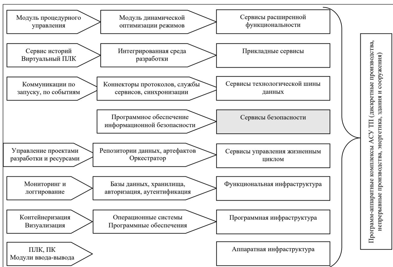
Рисунок 3 – Многоуровневая архитектура открытой АСУ ТП O-PAS [10; 11]
